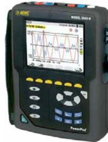
Figura 5.37 Analizador de calidad de energía trifásico PowerPad® Modelo 3945-B. Adaptado de [53]
